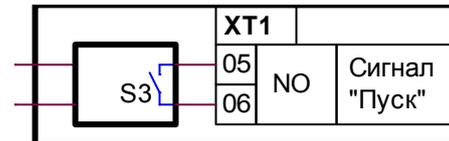
16. Управляющие контакты релейного модулей, подключаемые к клеммам ХТ1:5 – ХТ1:6, должны иметь коммутационную стойкость не менее:
