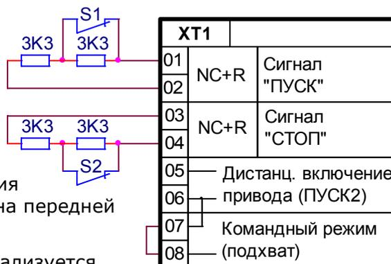
3. Если клеммы ХТ1:7 – ХТ1:8 замкнуты перемычкой, то реализуется командный режим управления. В этом случае для пуска привода достаточно даже кратковременного размыкания управляющего контакта S1 (Сигнал «ПУСК»). Привод включается и продолжает работу даже если управляющий контакт S1 вновь замкнётся. В качестве контакта S1 обычно используется пусковой контакт прибора пожарной сигнализации.
