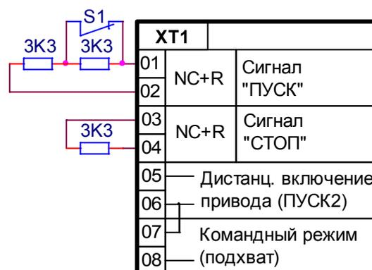
15. Если используемая на объекте система пожарной сигнализации имеет в своём составе адресные релейные модули, то сигнал "ПУСК" также может подаваться замыканием «сухих» контактов релейного модуля. Релейный модуль должен устанавливаться внутри шкафа управления при монтаже шкафа на объекте. Контроль исправности линии связи между адресным релейным модулем и приборами системы должен обеспечиваться средствами системы пожарной сигнализации.
