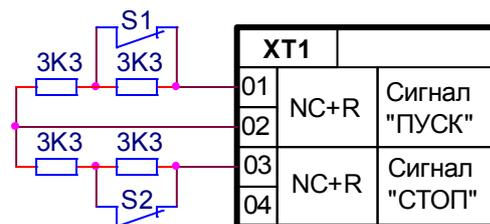
6. При одновременной подаче обоих сигналов, сигнал «СТОП» имеет приоритет.
