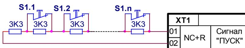
10. Все указанные выше источники пускового сигнала могут объединяться в один пусковой шлейф, подключаемый на клеммы ХТ1:(1,2). Шлейф должен выполняться в виде двухпроводного луча. Оконечный резистор (не шунтируемый никаким контактом) должен размещаться в конце луча, наиболее удалённом от шкафа (см. схемы выше).
